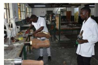
Termoformatura dei modelli fresati con la tecnologia cad/cam 3D
